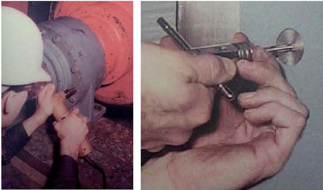
孔口平面，转孔后攻螺纹
