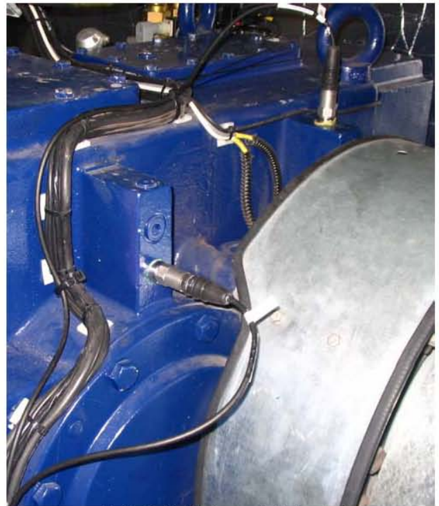
齿轮箱的轴向和垂直方向上 螺栓安装的通用型加速度振动传感器
