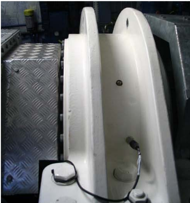
安装在主轴承水平轴上的 低频加速度振动传感器
